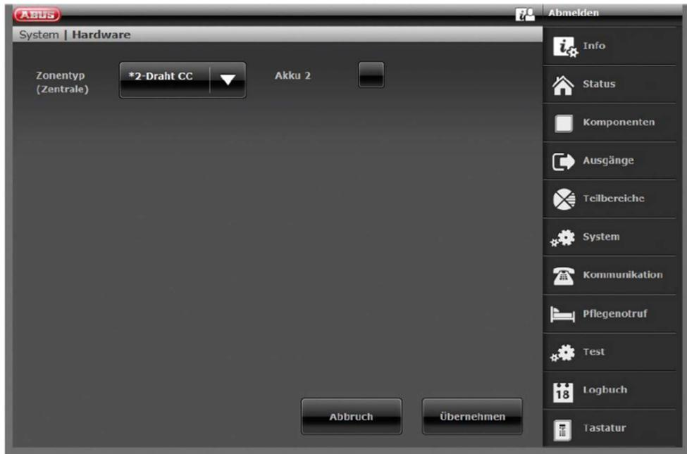
Konfiguration der Drahtzone 301 als Schlüsselschalter Dauer an der Secvest
