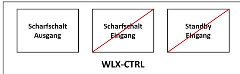
Es wird nur der Scharfschalt-Ausgang der wAppLoxx Pro Control Plus konfiguriert, aber nicht verdrahtet. Dadurch ist es möglich, durch einen Scharfschalt-Befehl die Zylinder zu sperren, bis ein gültiges Scharf/Unscharf-Schaltmedium präsentiert wird.
